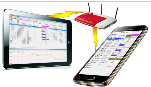
Abb. 7 Fernabfrage der Messwerte auf dem Smartphone über das WLAN im lokalen Netzwerk: Einen Stecker ziehen und live die Lastveränderung beobachten
